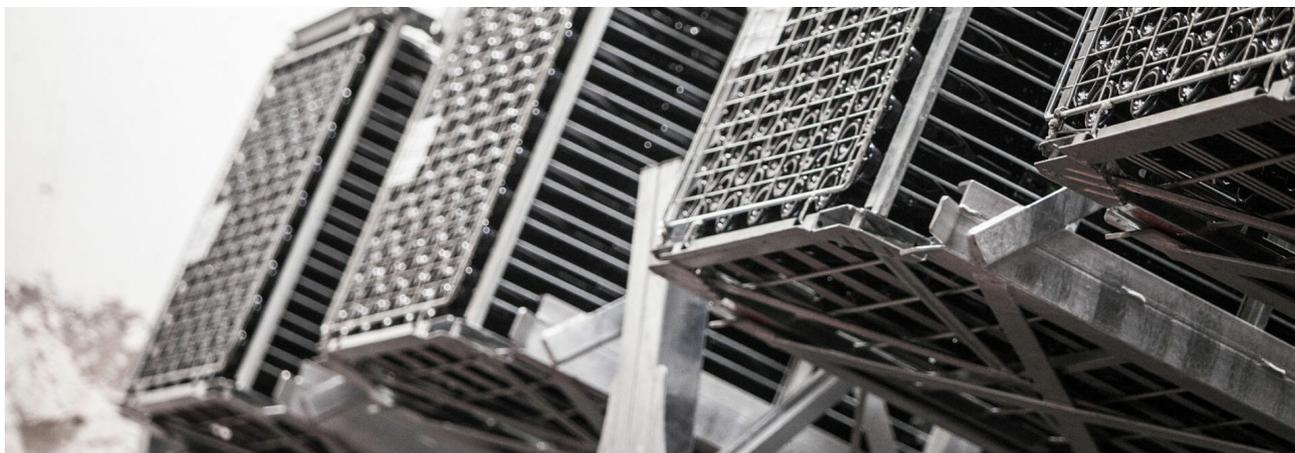
Equipamento projetado para a remoção e precipitação do depósito de acordo com o método clássico. Construção simples e robusta em aço galvanizado quente para evitar qualquer problema de corrosão. Carga e descarga de caixas com uma empilhadeira simples, mesmo do tipo manual. Possibilidade de personalizar os movimentos do "Remuage" com simples programação de software.
